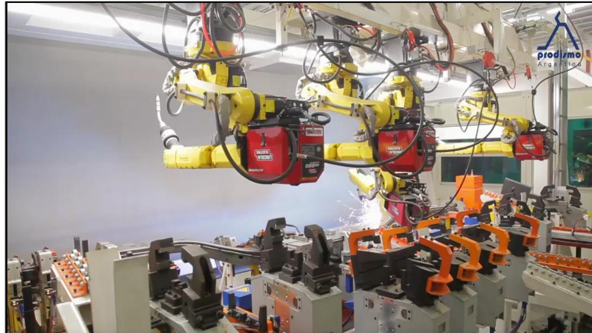
Soldadura MIG / MAG
